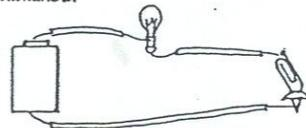
4. ต่อดวงจไฟฟ้าโดยใช้สายไฟ หลอดไฟ และคลิปหนีบกระดาษ โดยต่อลวดทองแดงที่ปลายสายไฟทั้ง 2 ข้าง ให้เข้ากับหมุดทั้ง 2 ตัว
