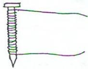
3. นำปลายลวดทองแดงในข้อ 1 ข้างหนึ่งสอดเข้าขั้วบวกของด่านไฟฉายด้วยเทปใส และปลายลวดทองแดงอีกข้างหนึ่งสอดเข้าขั้วลบของด่านไฟฉาย (ดังรูป)
