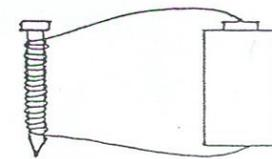
4. นำตะปูที่พันลวดทองแดงและสอดเข้ากับด่านไฟฉายในข้อ 3 แล้วเข้าใกล้ผงตะไบเหล็กให้มากที่สุด สังเกตและบันทึกผลที่เกิดขึ้น
