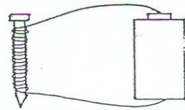
4. นำตะปูที่พันลวดทองแดงและสอดเข้ากับด่านไฟฉายในข้อ 3 แล้วเข้าใกล้ผงตะไบเหล็กให้มากที่สุด สังเกตและบันทึกผลที่เกิดขึ้น
